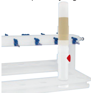
그림. DigiFILTER를 Manifold에 장착한 모습
